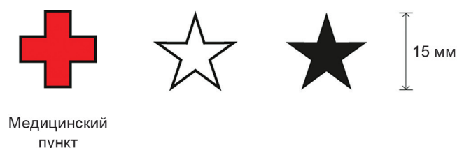
Рисунок 22 — Примеры рельефных символов различной геометрии
