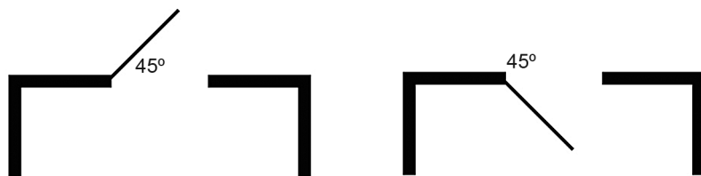
Рисунок 32 — Наружное и внутреннее открывание одностворчатой двери
